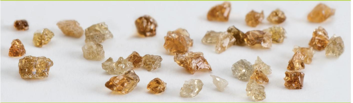
**HOCHOFENSCHLACKE** ist ein Einwegstrahlmittel auf Basis von granulierter Hochofenschlacke aus der Stahlproduktion (Hüttensand). Das Produkt entspricht den Anforderungen nach DIN EN ISO 11126-6 N/FE/G sowie des Arbeitsschutzes gemäß BGR 500, Teil 2, Kapitel 2.24 „Arbeiten mit Strahlgeräten(Strahlarbeiten)“.
