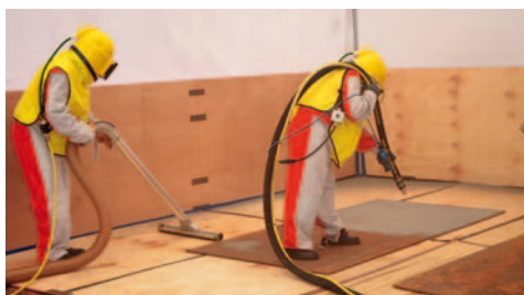
Eine wirtschaftliche und umweltfreundliche Lösung: Bis zu 30 Prozent der gesamten Strahlkosten können durch das Recycling von Strahlmitteln eingespart werden.
