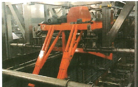
Die Grafik (o.) veranschaulicht das Funktionsprinzip des Verfahrens. Während des Beschichtungsprozesses fährt ein Schlitten, auf dem zwei Pumpen montiert sind, vor der Karosserie her. Mithilfe der Pumpen wird ein großer Volumenstrom erzeugt, der eingeschlossene Luftblasen verdrängt.
